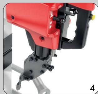
**UTENSILE LEVERLESS BREVETTATO**, consente lo smontaggio del pneumatico tramite un solo comando: nessun utilizzo della leva alza-talloncini. Utensile automatico dotato di inserti di protezione per i cerchi.
