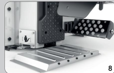
**IL KIT RULLIERE (basculante e a pavimento) BREVETTATO**, è ergonomica e di facile installazione; agevola tutte le operazioni di stallonatura (optional per tutte le versioni).
