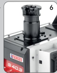
**SISTEMA DI BLOCCAGGIO RUOTE UNIVERSALE BREVETTATO** fornito con albero di bloccaggio centrale manuale per cerchi da 12" a 30" pollici. Accessori opzionali di bloccaggio sono disponibili a richiesta per cerchi con geometrie fuori standard.
