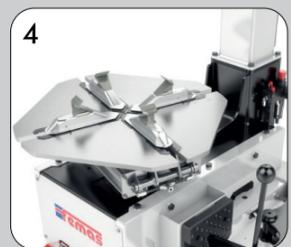
**PIATTO AUTOCENTRANTE** con capacità di serraggio da 12" a 24". La speciale geometria del gruppo di serraggio è dotata di bielle curve di guida che mantengono costante la forza di bloccaggio al variare del diametro del cerchio.
