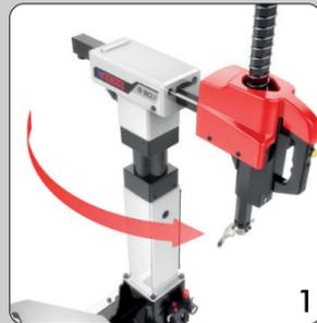
**PALO VERTICALE**, in configurazione extra-rigida, dotato di un sistema elicoidale a rotazione laterale che permette di avere la zona di lavoro libera da ingombri e posizionare la macchina vicino alla parete con recupero degli enormi spazi "morti" propri della maggior parte degli smontagomme automatici.
