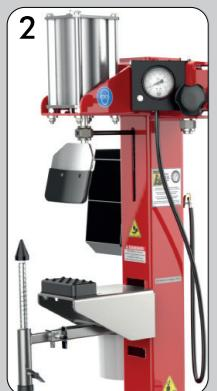
**STALLONATORE PNEUMATICO CON CILINDRO A DOPPIO EFFETTO** con speciale sistema di stallonatura orizzontale che permette un controllo costante dell'operatività durante le fasi di lavoro rimanendo sempre in comoda posizione eretta. L'adozione dell'appoggio ruota regolabile in tre differenti posizioni in altezza permette di operare comodamente su ogni tipo e dimensione di ruota: motocli, go-kart, giardinaggio, scooter e quad.
