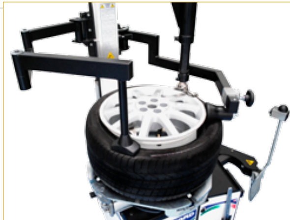
Rullo premi-tallone con regolazione in profondità e ritorno automatico. Adjustable bead pressing roller with automatic return system.
